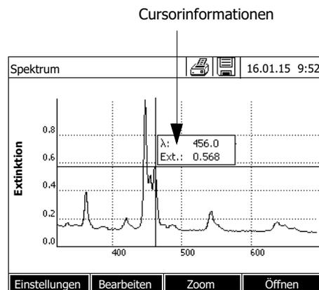
Der Cursor besteht aus einer waagrechten und einer senkrechten Linie, die sich in einem Punkt der Kurve kreuzen. Ein Kästchen zeigt die x- und y-Werte des Kurvenpunkts an.
