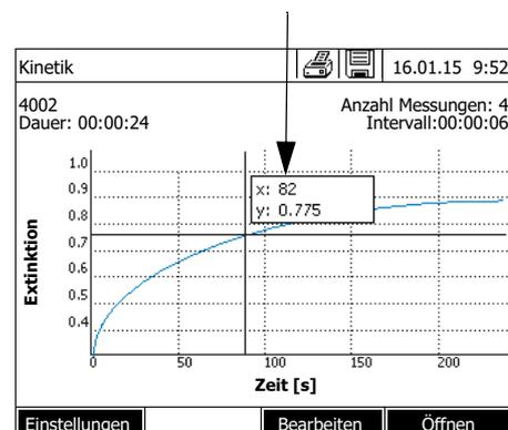
Der Cursor besteht aus einer waagrechten und einer senkrechten Linie, die sich in einem Punkt der Kurve kreuzen. Ein Kästchen zeigt die x- und y-Werte des Kurvenpunkts an.
