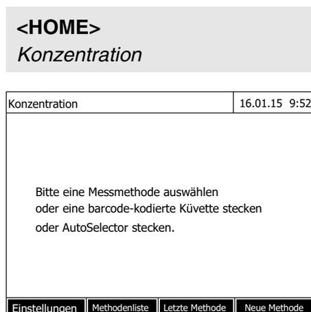
Durch Stecken einer Küvette mit Barcode wird direkt die Messung ausgelöst.
