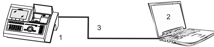
Bild 4-7 Direkte Verbindung (Ethernet-Kabel)
