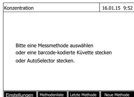
Durch Stecken einer Küvette mit Barcode wird direkt die Messung ausgelöst.
